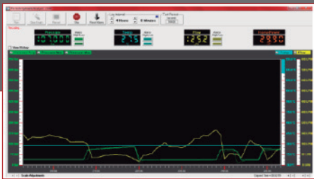
Medición de Caudal y Presión de una Bomba con Desgaste en sus Componentes Internos
